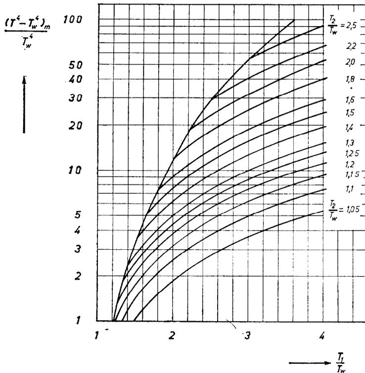
ABB. 1. Für reine Wärmestrahlung massgebender Mittelwert  $(T^4 - T_w^4)_m / T_w^4$  nach genauer Berechnung von Binder
