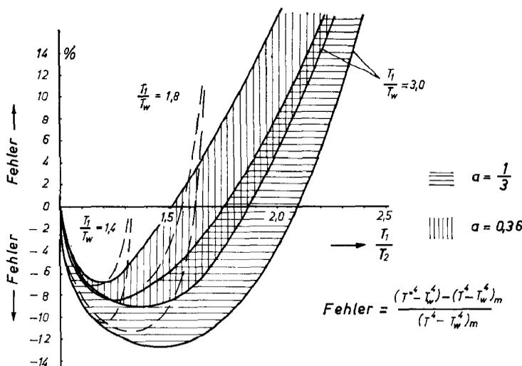
ABB. 2. Fehler des einfachen Verfahrens mit  $a = \text{const}$  in Gleichung (11) bei reiner Wärmestrahlung.
