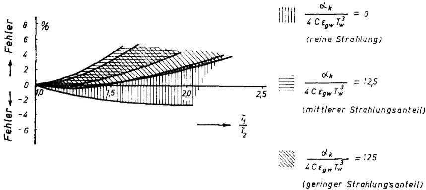
ABB. 8. Fehler des Verfahrens nach Gauss bei Einfluss der Konvektion mit der abgeänderten Konstanten  $k = 0,185$ . ( $C = C_s =$  Strahlungszahl des schwarzen Körpers.)
